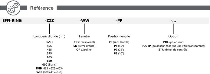
(1): A 365nm, pas de lentille, vitre transparente est en PMMA special UV.
