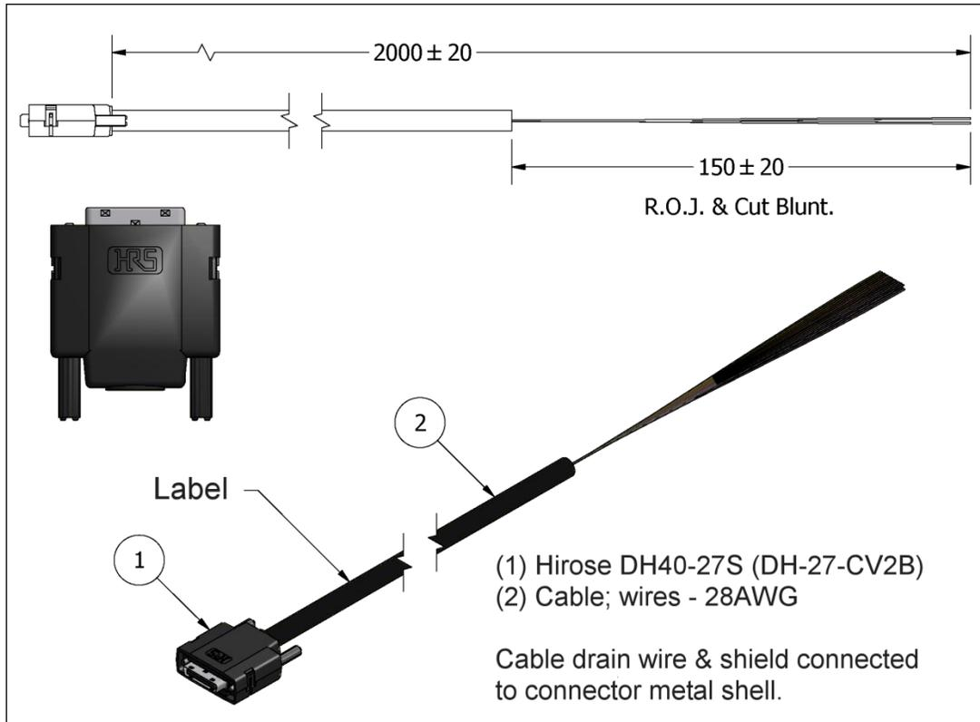
Figure 36: DH60-27P Cable No. OR-YXCC-27BE2M1 Detail
