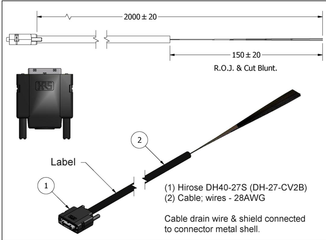
Figure 37: DH60-27P Cable No. OR-YXCC-27BE2M1 Detail
