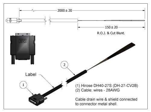
Figure 43: DH60-27P Cable No. OR-YXCC-27BE2M1 Detail
