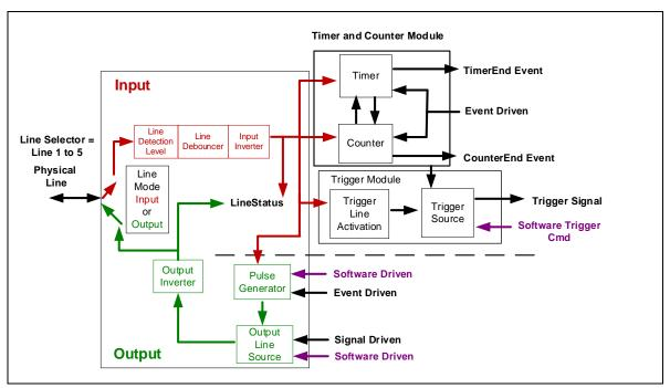
Figure 46: I/O Module Block Diagram
