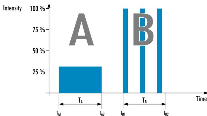
Fig. 5-33: Example: 25% PWM load
