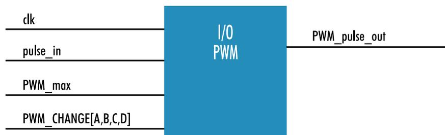
Fig. 5-36: The PWM module
