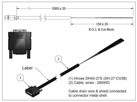
Figure 36: DH60-27P Cable No. OR-YXCC-27BE2M1 Detail
